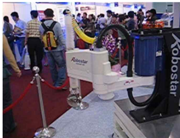
그림 1.8 ■ 스카라(SCARA) 로봇(다사 로봇 제공)
